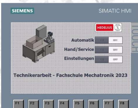
Zur Visualisierung und Funktionsüberprüfung wurde ein Simulationsstand entwickelt, mit dem das SPS-Programm getestet oder die korrekte Funktionsweise an einem CNC – Bearbeitungszentrum kontrolliert werden kann.
